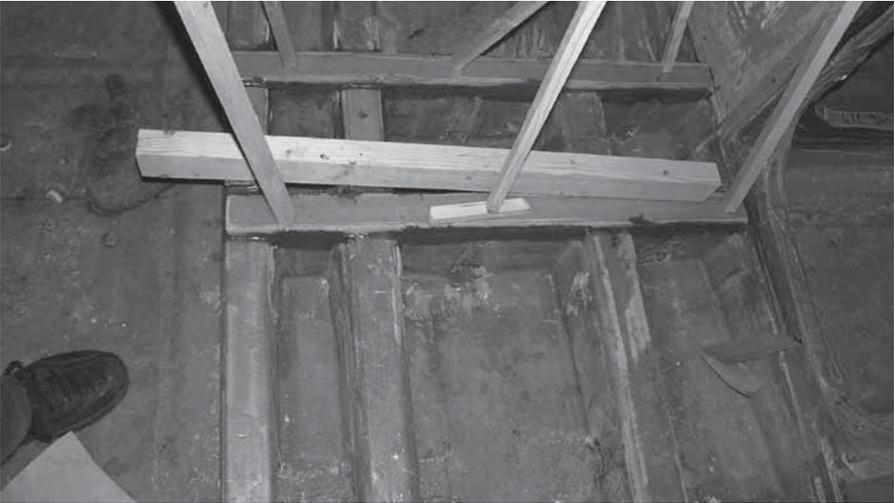
Über die vorderen Stringer wird ein überlaufender Obergurt laminiert
