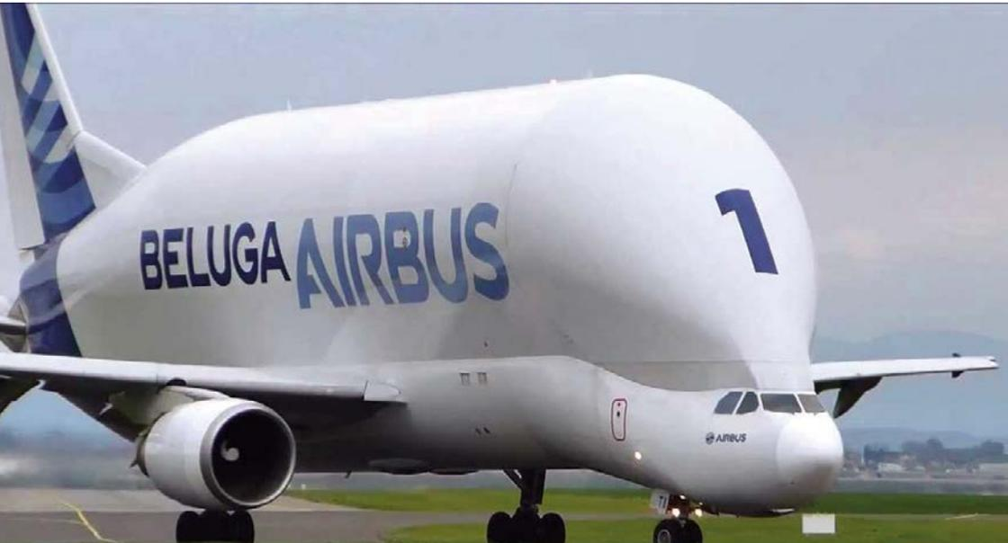
Die Beluga, der "Großraumtransporter" für vormontierte Flugzeugteile
