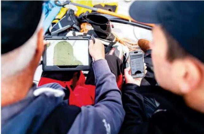
An Bord der „Tormund“ wird nur mit dem Tablet navigiert. Jegliche fest installierte Hardware würde der Feuchtigkeit unter Deck der Rennyacht nicht standhalten
